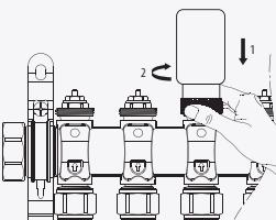
Montieren sie den THB auf das Ventil im Rücklauf. Stellen Sie sicher dass der THB fest auf dem Ventil sitzt. Der THB ist im Auslieferzustand stromlos offen, um eine einfache Montage zu gewährleisten.
