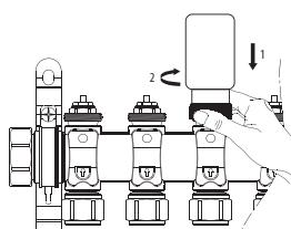
Fixez l'actionneur à équilibrage automatique aux vannes thermostatiques du collecteur de plancher chauffant, sur la barre de retour. Lors de l'installation du THB23030 / THB2430, assurez-vous qu'il est bien fixé sur le collecteur. L'actionneur est en position entièrement ouverte, dès la sortie de l'emballage, pour une installation facile.
