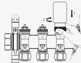
Monteer de Automatisch Balancerende Aandrijving op de thermostaatkleppen van de vloerverwarmingssverdeler, op de retourbalk. Zorg er bij de installatie van de THB23030 / THB2430 voor dat deze goed op de verdeler is bevestigd. De actuator is standaard volledig geopend om de installatie te vergemakkelijken.
