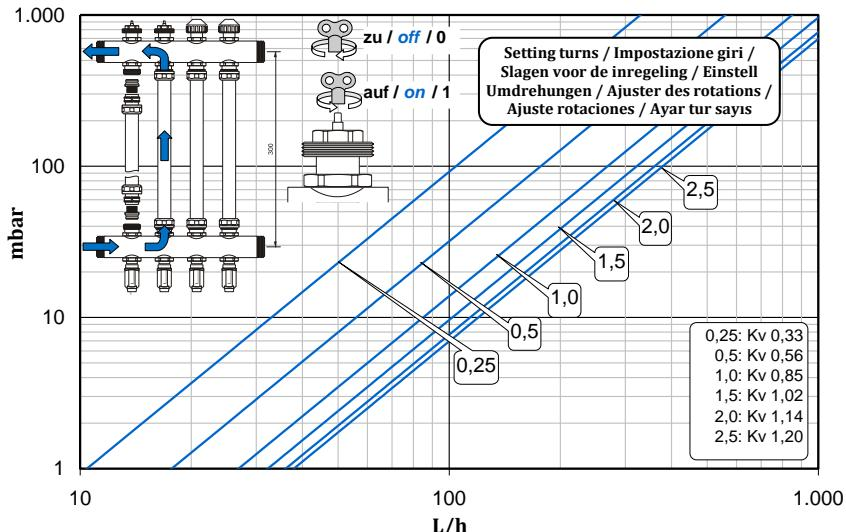
**ES** El diagrama de ajuste ya considera las pérdidas de presión individuales del caudímetro, de la válvula de control, así como de dos raciones de compresión.
